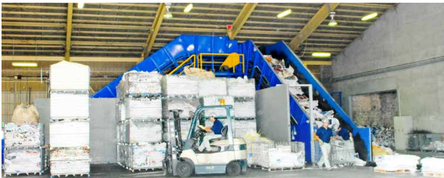
国内最大級の古紙ベラーマシン 250 馬力、W コンベア、時間処理量 20ト
